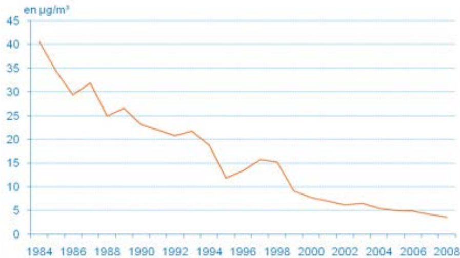
Reconstitution de la tendance moyenne en SO2 sur le parc d'Atmo PACA
